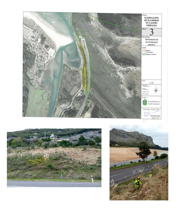
En los tres terrenos citados, se realiza un tratamiento mixto, es decir, por un lado, un desbroce de la parte aérea de la planta con motodesbrozadora y por otro, transcurridas entre dos/tres semanas, se aplica herbicida de forma individualizada a cada planta. La aplicación de herbicida se realiza siempre de acuerdo a la legislación y protocolos vigentes.
