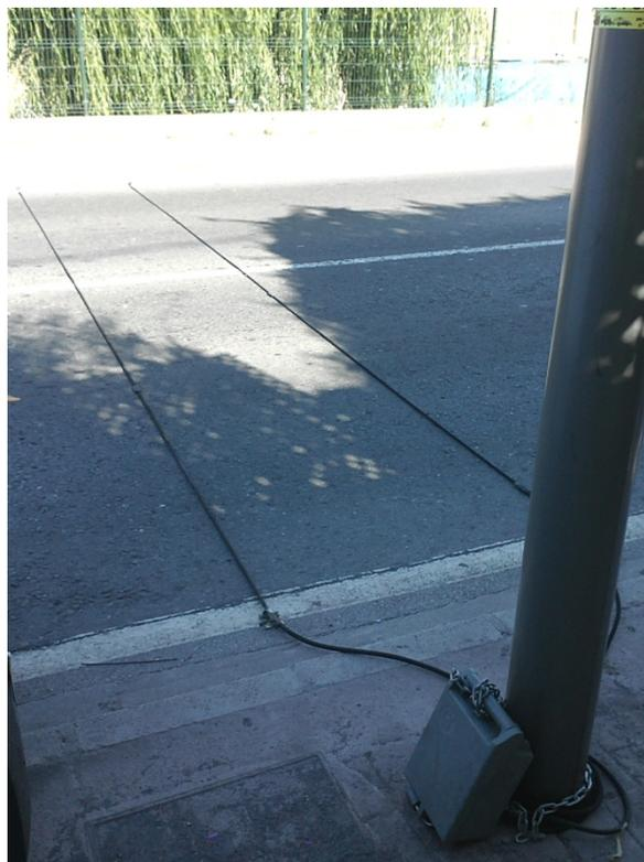
Imagen 18. Aforo de tubo neumático en la Carretera de Sámano (CC Eroski).
