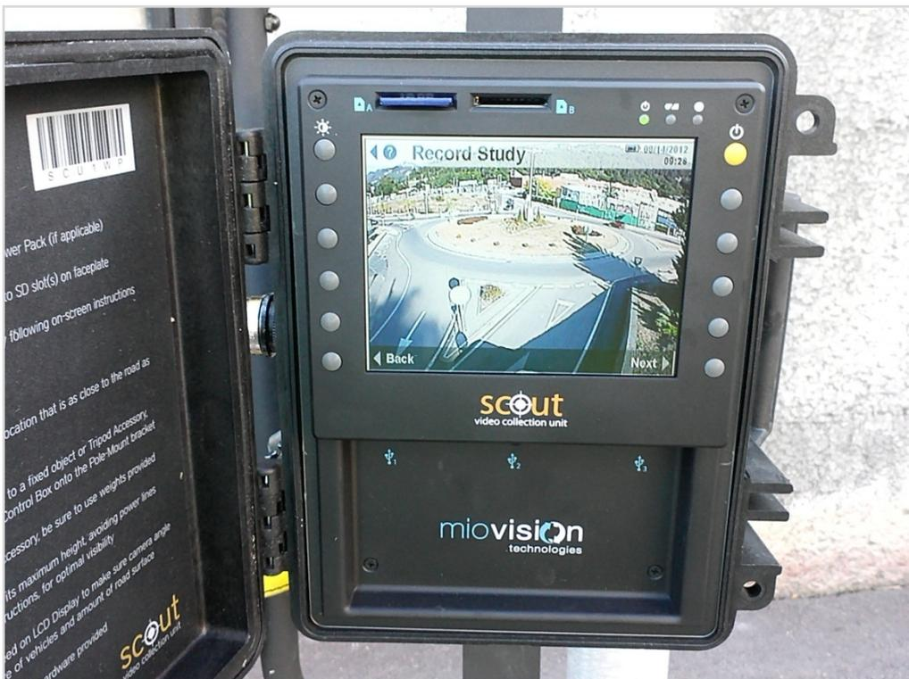
*Imagen 25. Intersección tipo glorita (Carretera a Sámano acceso a CC. Eroski) filmada con cámara de Visión artificial para estudiar la distribución del flujo vehicular en la misma y detalle del equipo.*
