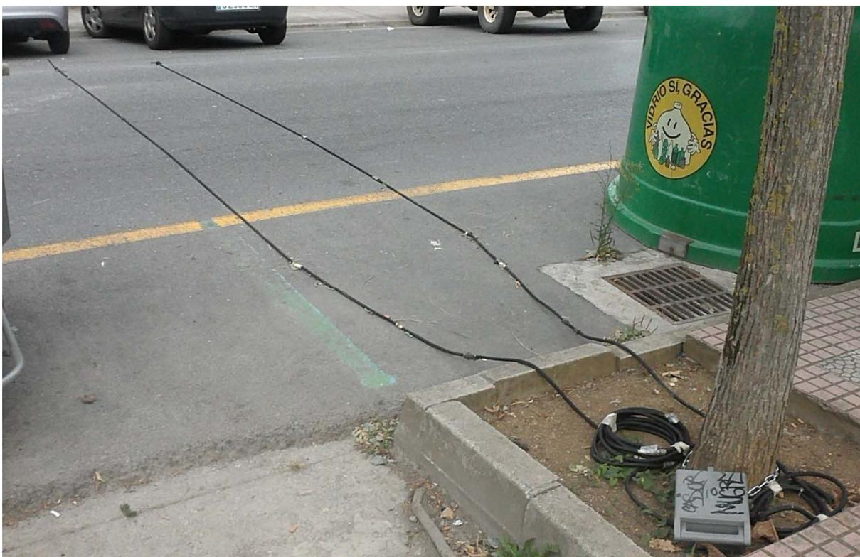
Imagen 16. Aforo de tubo neumático en la Calle Leonardo Rucabado (C/ A.Linares).
