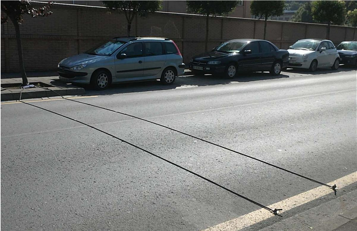
Imagen 17. Aforo de tubo neumático en la Calle Leonardo Rucabado (Estación de bus).
