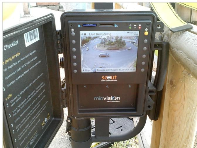
*Imagen 23. Intersección tipo glorita (Carretera a Sámano con Leonardo Rucabado) filmada con cámara de Visión artificial para estudiar la distribución del flujo vehicular en la misma y detalle del equipo.*
