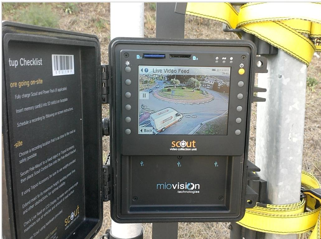
Imagen 24. Intersección tipo glorita (Calle Silvestre Ochoa- entrada desde A-8) filmada con cámara de Visión artificial para estudiar la distribución del flujo vehicular en la misma y detalle del equipo.
